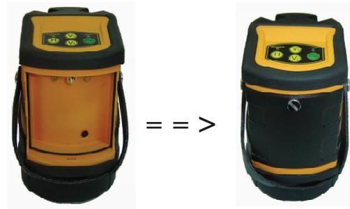
Alkalinebatterien ins Batteriefach einlegen und Batteriefach ins Gerät einschrauben. / Put in Alkaline batteries in the corresponding case and fix battery case in the instrument.
