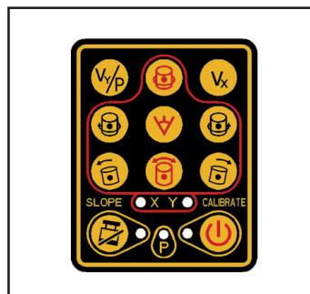
Apasati tasta . Led-ul va palpări și automat va începe procedura de autonivelare să lucreze. Pe timpul acesta, toate tastele sunt inaccesibile, pana cand procesul este complet.
