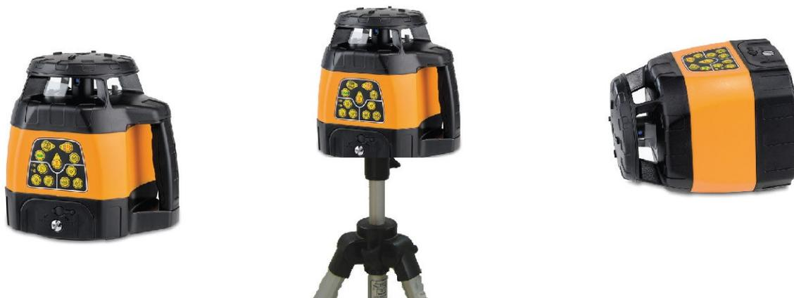
Dupa pornire, LED-ul nivelei clipeste, indicatie ca procesul de autonivelare este inceput. Se va roti doar in momentul in care este autonivelat. Daca nu porneste rotirea, inseamna ca este in afara intervalului de autonivelare si trebuie corectata inclinarea trepidului, sau gasita o alta suprafata neteda.
