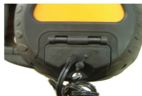
Încărcarea bateriilor în interiorul sau exteriorul instrumentului Charging battery inside or outside of instrument
