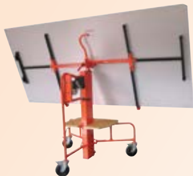
Încărcare cu o placă de 1,20 m x 2,50 m, montare pe orizontală.
