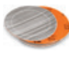
DISC DE ȘLEFUIT PYRAMIX Prin perforația discurilor abrazive cu scai Pyramix, acestea pot fi utilizate și după uzarea suprafeței periferice. Ø 115 mm. pentru îndepărtarea zgărieturilor foarte fine, șlefuire graduală, reducerea adâncimii asperităților
