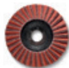
DISC LAMELAR COMBINAT Ideal pentru prelucrarea oțelului superior în vederea eliminării cordoanelor de sudură și finisării într-o singură etapă de lucru. Combinația dintre procesul de îndepărtare rapidă a materialului și calitatea perfectă a suprafețelor.
