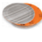
DISC DE ȘLEFUIT PYRAMIX Prin perforația discurilor abrazive cu scai Pyramix, acestea pot fi utilizate și după uzarea suprafeței periferice. Ø 115 mm. Pentru îndepărtarea zgărieturilor fine, șlefuire graduală, reducerea adâncimii asperităților
