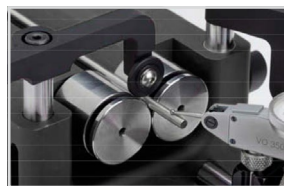
Niederhalter für verschiedene Durchmesser Spring loaded workpiece clamping system for different diameters
